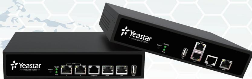
朗视TE系列是朗视针对电信运营商和企业用户而设计的电信级数字中继网关，支持1/2个E1 (30B+D) 接口，具备全并发语音处理能力；支持SIP协议与PRI/7号信令，支持语音、传真等服务，与IMS/软交换系统互通性良好，可满足在不同网络环境下的组网应用需求。
